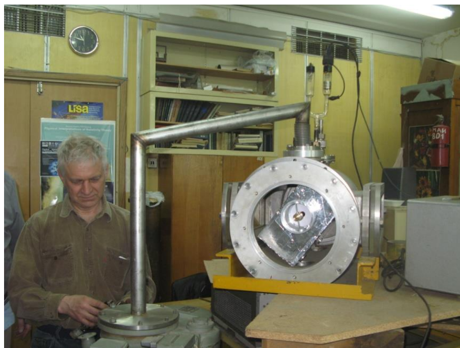
Барокамера с помещённым внутрь макетом НА
