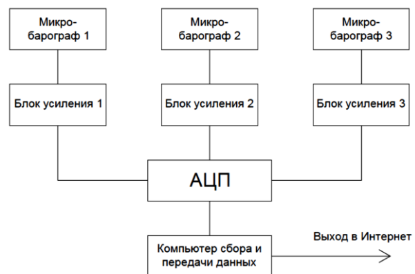
Рис. 2. Блок-схема сбора и передачи информации инфразвуковой ст. Торы
