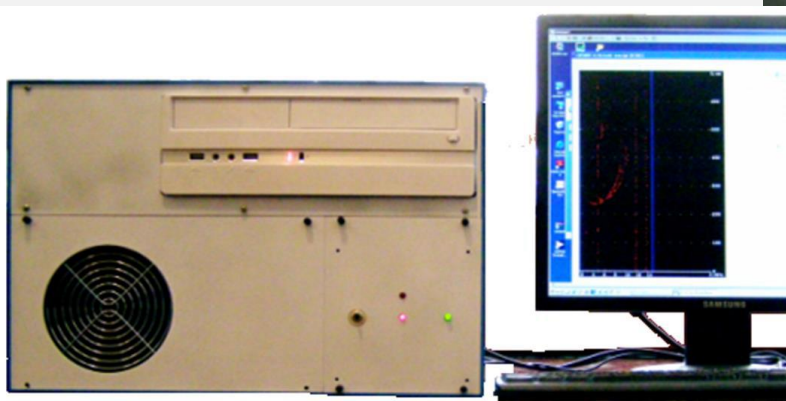
РФ - Многофункциональный ЛЧМ ионозонд ИСЗФ СО РАН
