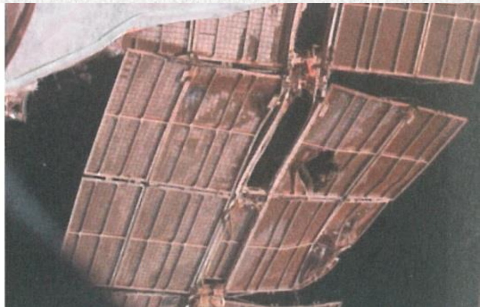
Катастрофические повреждения солнечных панелей модуля «Спектр» ОС «Мир»
