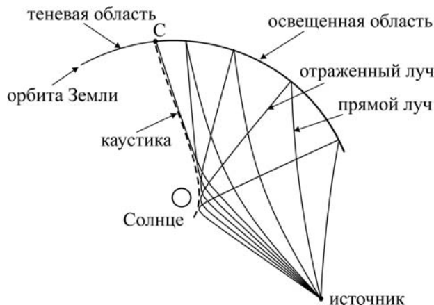
Рис. 1. Формирование регулярной каустики в солнечной короне. Каустика пересекается с орбитой Земли в точке С.
